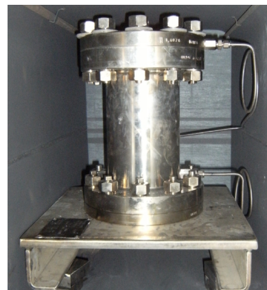
Рис. 4. Штамп для горячей листовой вытяжки с противодействием в печи
